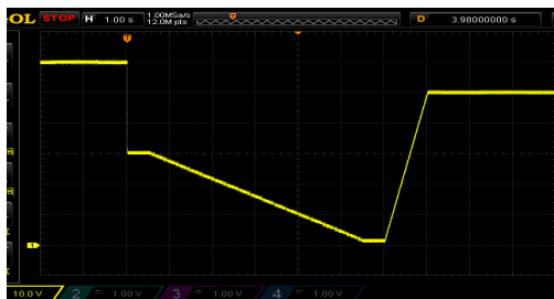
图 12. 仿真电池供电瞬降试验
