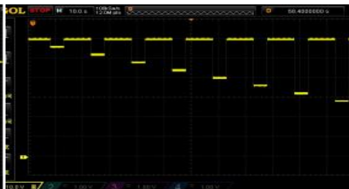
图 11.IS016750-2 电压瞬间中断试验曲线
