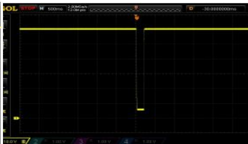
图 9.IS016750-2 电压瞬间中断试验曲线
