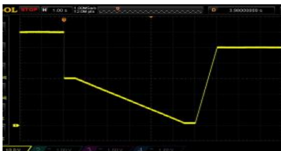
图 12. 仿真电池供电瞬降试验
