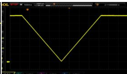
图 13. 仿真电池缓降及缓升供压试
